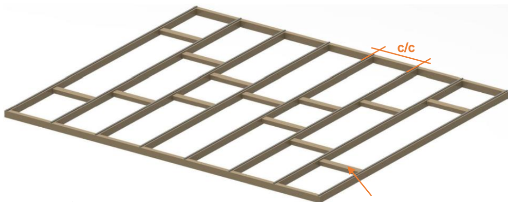
Eksempel på avstiving av bjelkelag.
