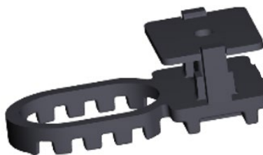
Figur 14: Alternativt startklip: Modifisert RASK-klip.
