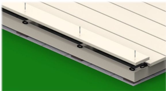
Figur 19: Plasser avstandsstykker på kanten av bjelken.
